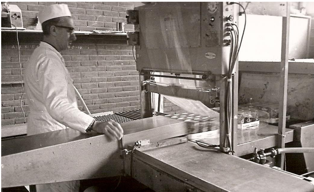
De in begin 1968 in gebruik genomen volautomatische krimpfolieverpakkingsmachine.
